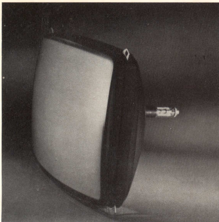
Fig. 5 - Cinescopio Philips a colori da 26" con angolo di deflessione di 110°.
